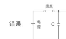
提示：虽然断开时对于电弧的消弧效果非常好，但接点开路时在 C 中储藏了电能，接点闭合时 C 的短路电流流过接点，容易发生接点粘连。
